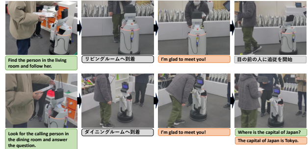
図4 2個目までのタスクの競技の様子。音声合成エンジンの発話を緑、ロボットの発話をオレンジで示している
