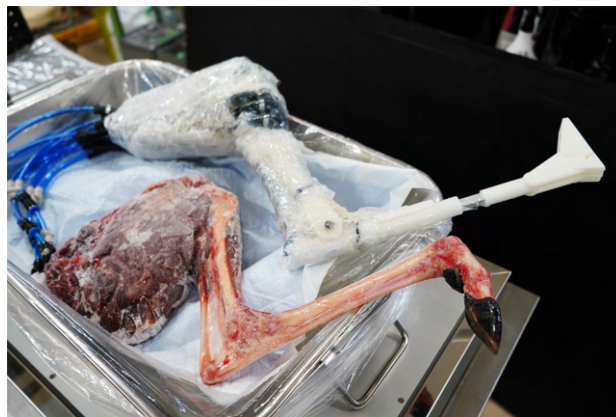
図1 シカ後脚を模倣した深層生体模倣ロボット
