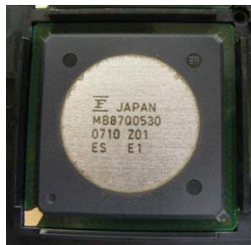
図 1 ステレオビジョンLSIの外観
